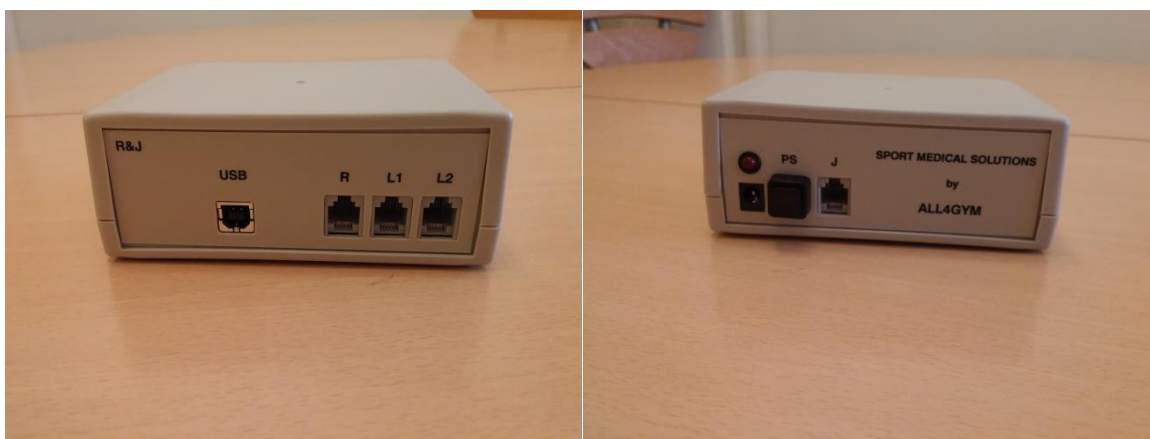
Slika 1: Prednja (levo) i zadnja strana (desno) merno-akvizicione kutije
