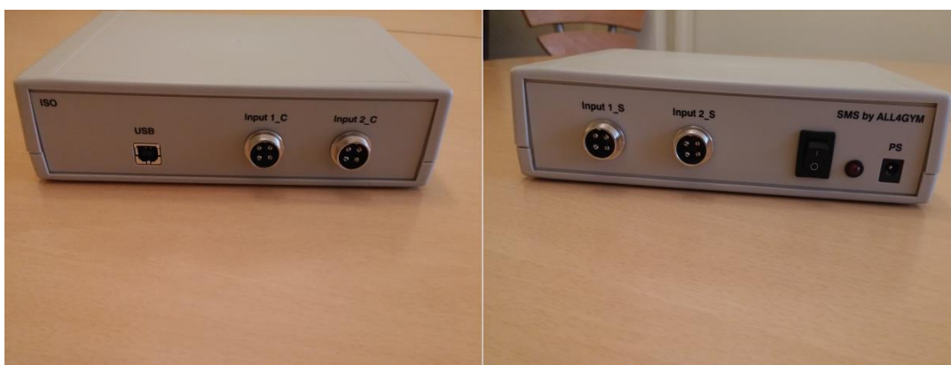
Slika 1: Prednja (levo) i zadnja (desno) strana merno-akvizicione kutije
